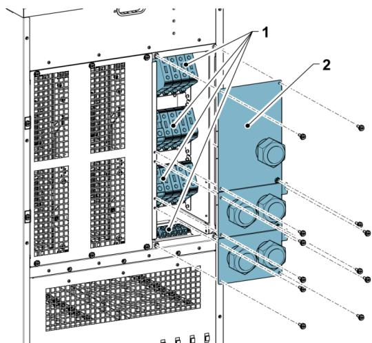
Рисунок 13. Положение сальниковой панели и разъемов на ИБП 93PS 30-40 кВт
