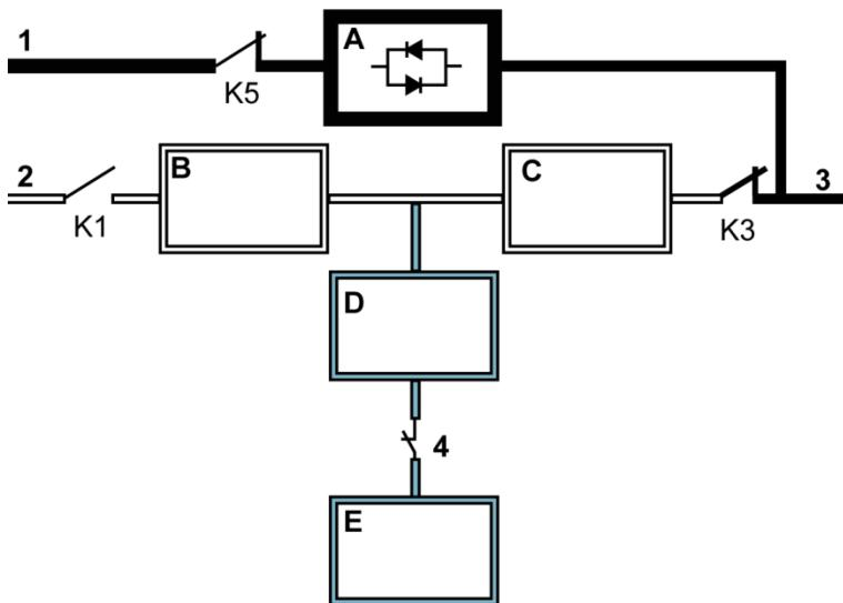
Рис. 5. Путь прохождения тока через ИБП в режиме энергосбережения
