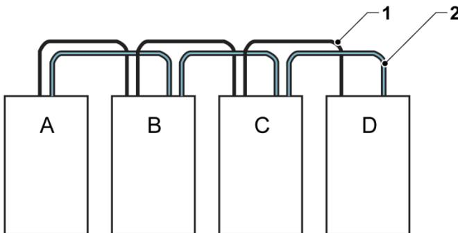
Рисунок 19. Упрощенная схема проводки для сети CAN и параллельного монтажа для системы ИБП с параллельным подключением
