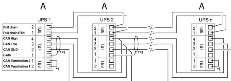
Рисунок 21. Проводка для сети CAN и параллельного монтажа для системы ИБП с параллельным подключением без выходных выключателей модулей
