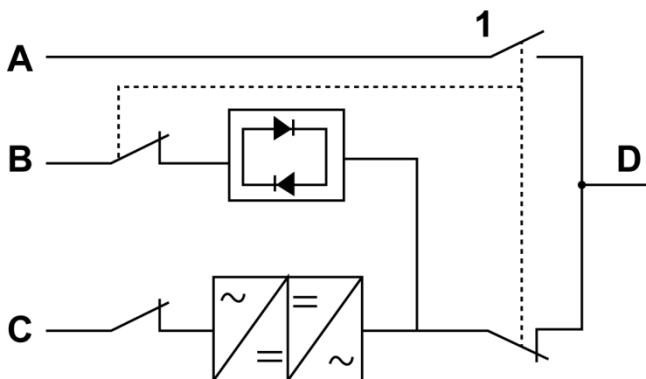
Рисунок 36. Режим двойного преобразования
