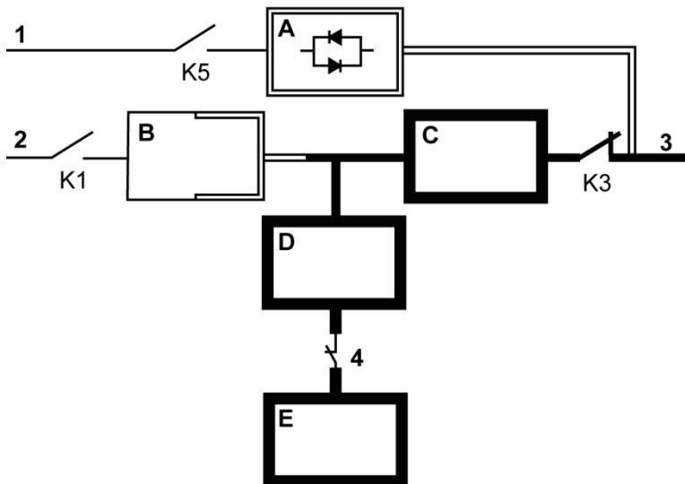
Рис. 6. Путь прохождения тока через ИБП в режиме работы от аккумулятора
