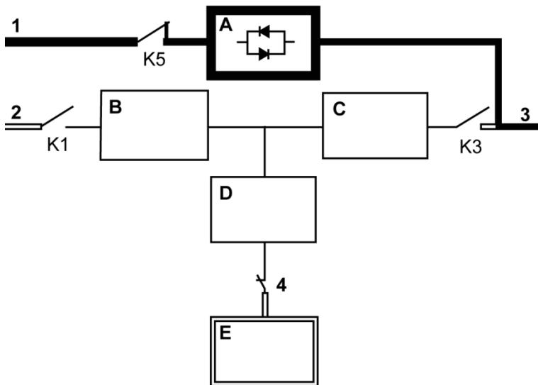
Рис. 7. Путь прохождения тока через ИБП в режиме байпаса
