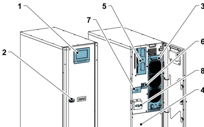
Рис. 2. Внутренние компоненты ИБП Eaton 93PS 8-20 кВт
