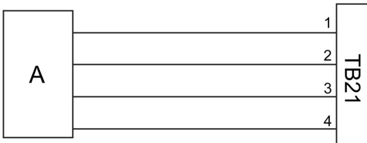
Рисунок 15. Проводка расцепителя аккумулятора, TB21
