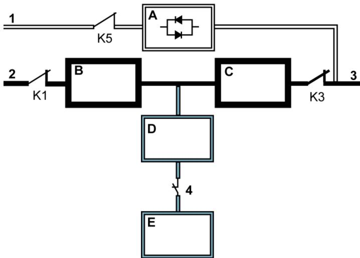
Рис. 4. Путь прохождения тока через ИБП в режиме двойного преобразования
