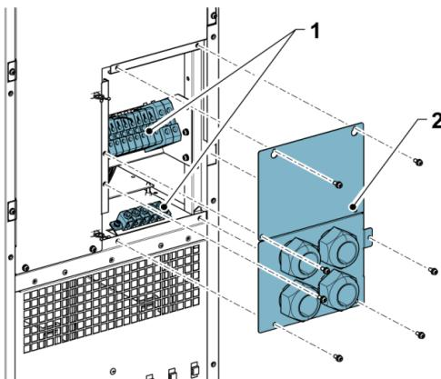
Рисунок 12. Положение сальниковой панели и разъемов на ИБП 93PS 8-20 кВт
