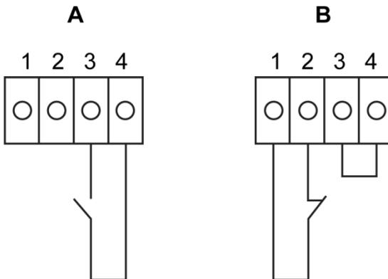
*Рисунок 16. Соединения для выключателя EPO**Таблица 11. Клеммы проводки удаленного EPO*
