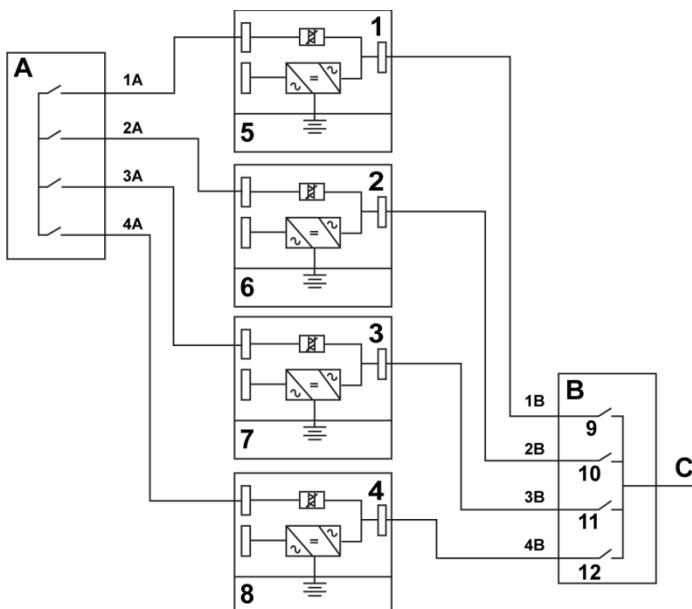
Рисунок 18. Принципиальная схема параллельного подключения систем ИБП
