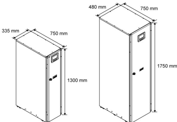
Рисунок 9. Габариты ИБП 93PS 8-40 кВт
